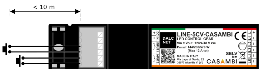
Figura 9: Schema di collegamento del comando locale per brevi distanze
