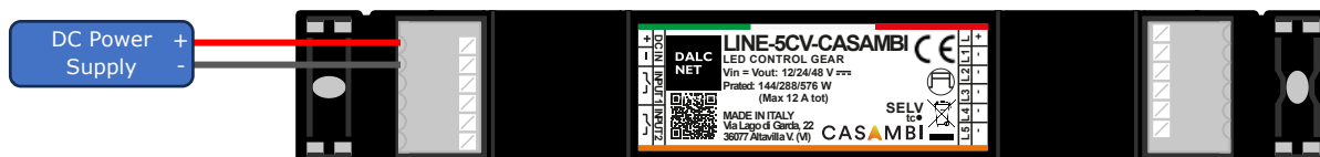
Figura 10: Schema di collegamento dell'alimentazione
